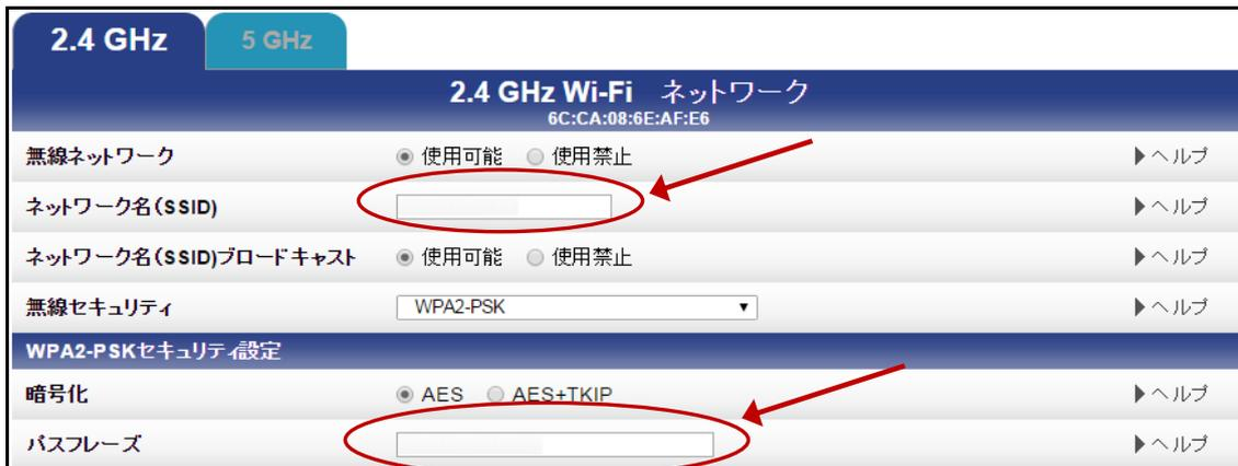
図 7-5: 2.4 GHz ネットワーク名 (SSID) とパスワードの変更画面
