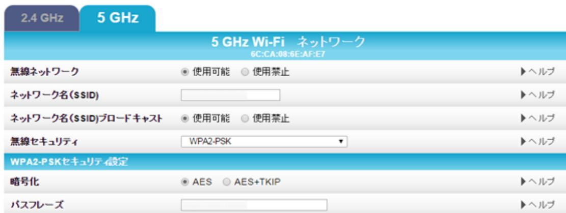
7-6: 5 GHz ネットワーク名 (SSID) とパスワードの変更画面図
